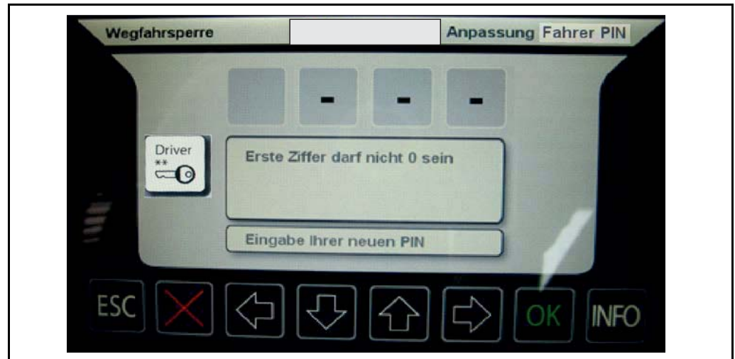
Fig. 5-38 Modification du PIN conducteur après autorisation
