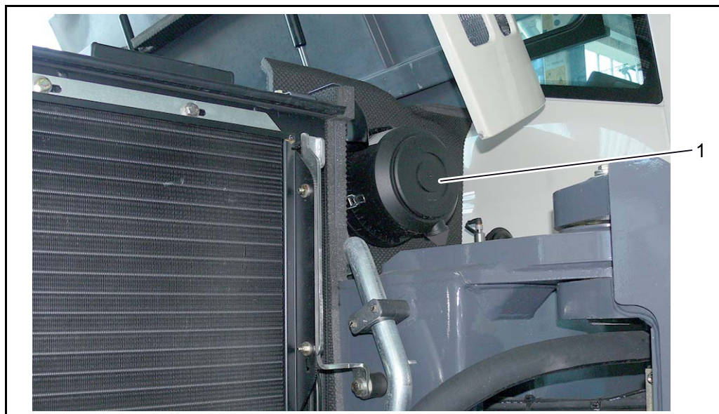
Fig. 6-9 Entretien du filtre à air
